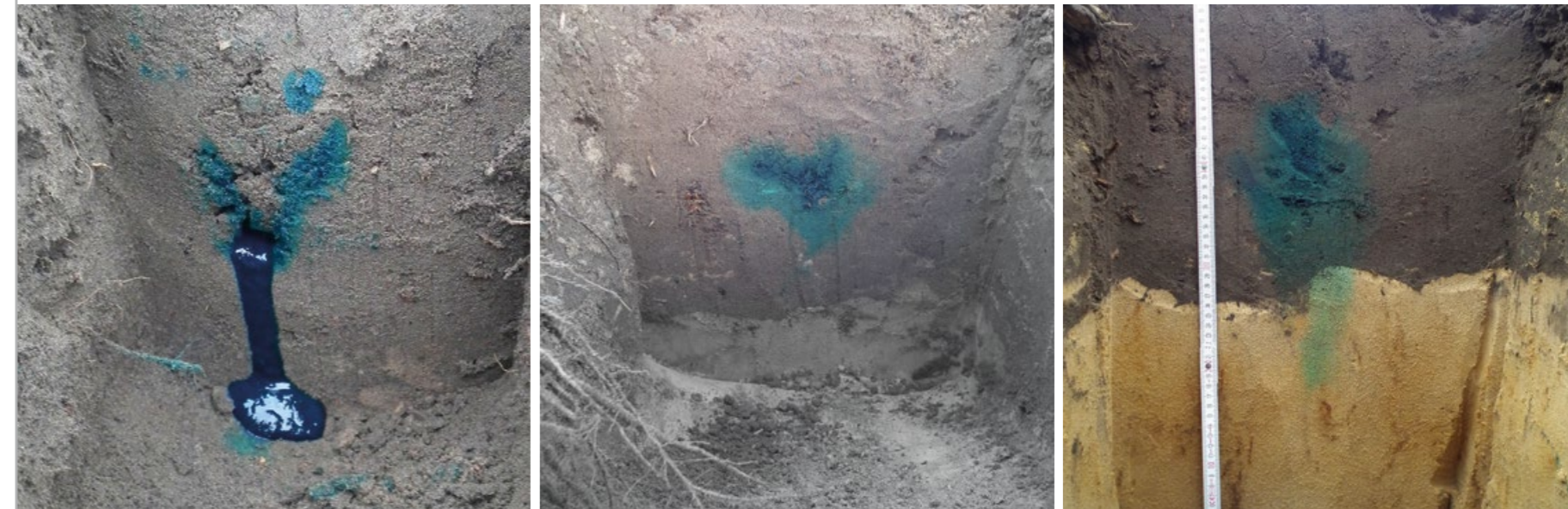
Die blau eingefärbte Gülle direkt nach der Injektion und wie sie sich im Anschluss im Boden verteilt.
