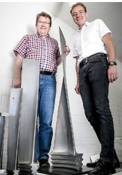
Prof. Dr. Christoph Hermann Richter (links) und Prof. Dr. Ulrich Krupp zeigen eine Turbinenschaufel, an deren Fuß drei Kerben an jeder Seite zu sehen sind.
