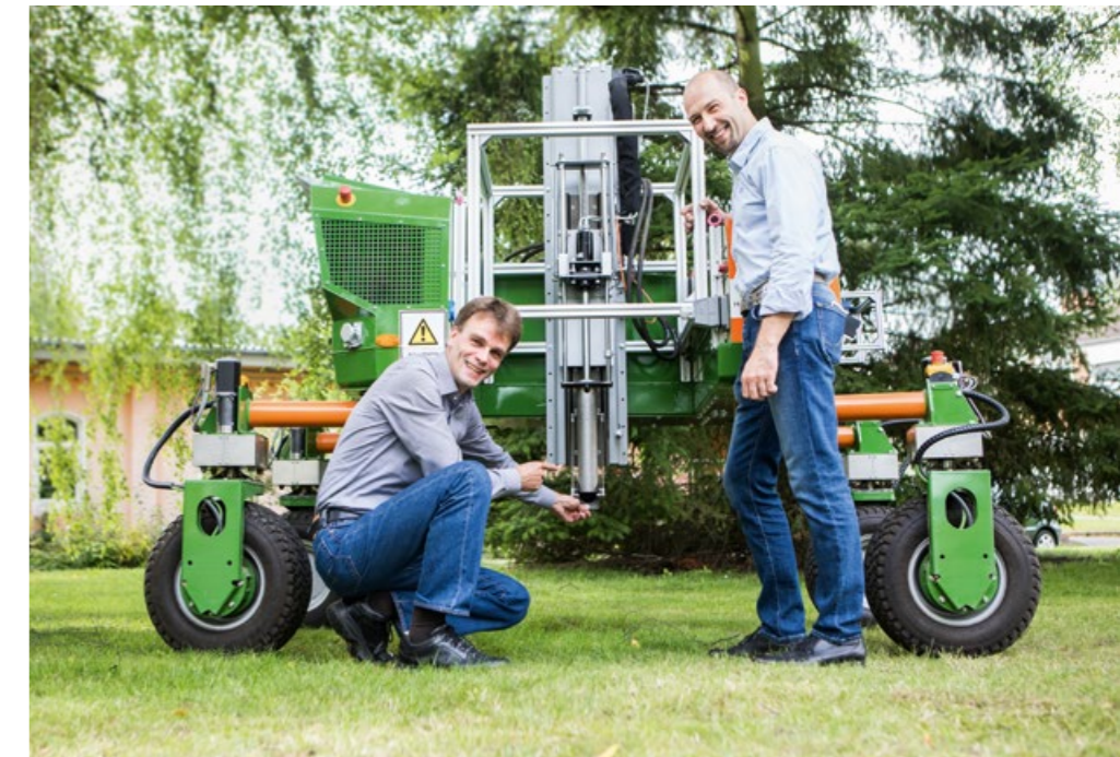
Die Projektmitarbeiter Dr. Stefan Hinck (links) und Vadim Tsukor stehen am autonomen Feldroboter „BoniRob“. Auch in dieses Gefährt lässt sich das mobile Bodenproben-Labor einbauen. Mit der unteren Röhre werden die Bodenproben entnommen. Bei der Analyse des Materials kommen Mikrosensoren (kleines Bild) zum Einsatz, die den Nährstoffgehalt, den pH-Wert und die Leitfähigkeit des Bodens erfassen können.
