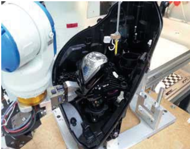
Abb. 2: Montage eines Lichtmoduls im koordinierten Betrieb beider Roboterarme
