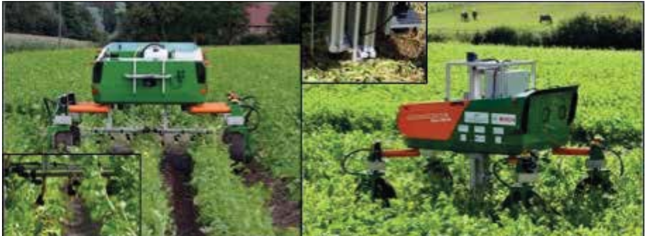
Abb. 1: Feldroboter BoniRob, links: mit Precision-Spraying-App, rechts: mit Penetrometer-App
