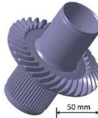
Abb. 1: 3D-gescannte Antriebswelle aus einem Motorrad
