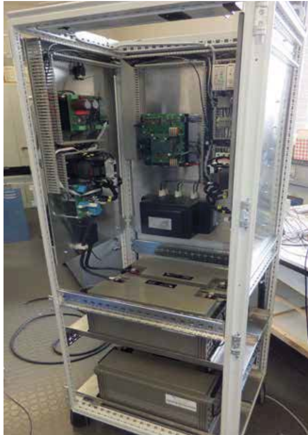
Dieses individuell gestaltbares Wechselspeichersystem für erneuerbare Energien war eines der drei Exponate des KEA – Kompetenzzentrums Elektronik & Antriebstechnik
