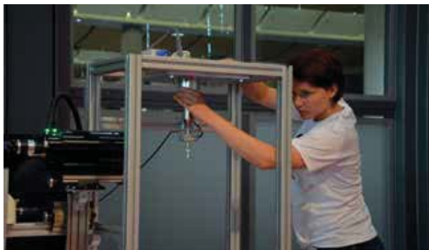
Montage einer Probe in die Ultraschallprüfmaschine auf dem Stand der Hochschule Osnabrück auf der Ideen-Expo
