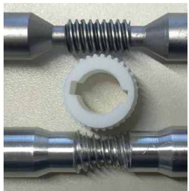
Abb. 2: Zylindrische (oben) und globoiden Schnecke (unten) zusammen mit einem Kunststoffstirnrad, die globoiden Schnecke wurde durch das neue Kaltwalzverfahren hergestellt
