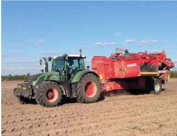
Abb. 4: Gezogener Kartoffelroder mit Zwischenbunker auf dem Kartoffelanbaubetrieb in Uelzen
