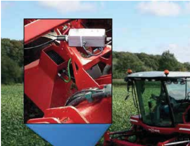
Abb. 2: Maxtron Zuckerrübenerntemaschine, links: Reihennavigation, rechts: Reinigungsqualitätskontrolle
