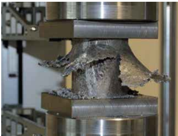
Abb.: (von oben): Potentielle Anwendungsdetails von Aluminiumschaum in Autositzen (Projektpartner Faurecia) und geschlossenzelliger Aluminiumschaum (Alulight) im Druckversuch
