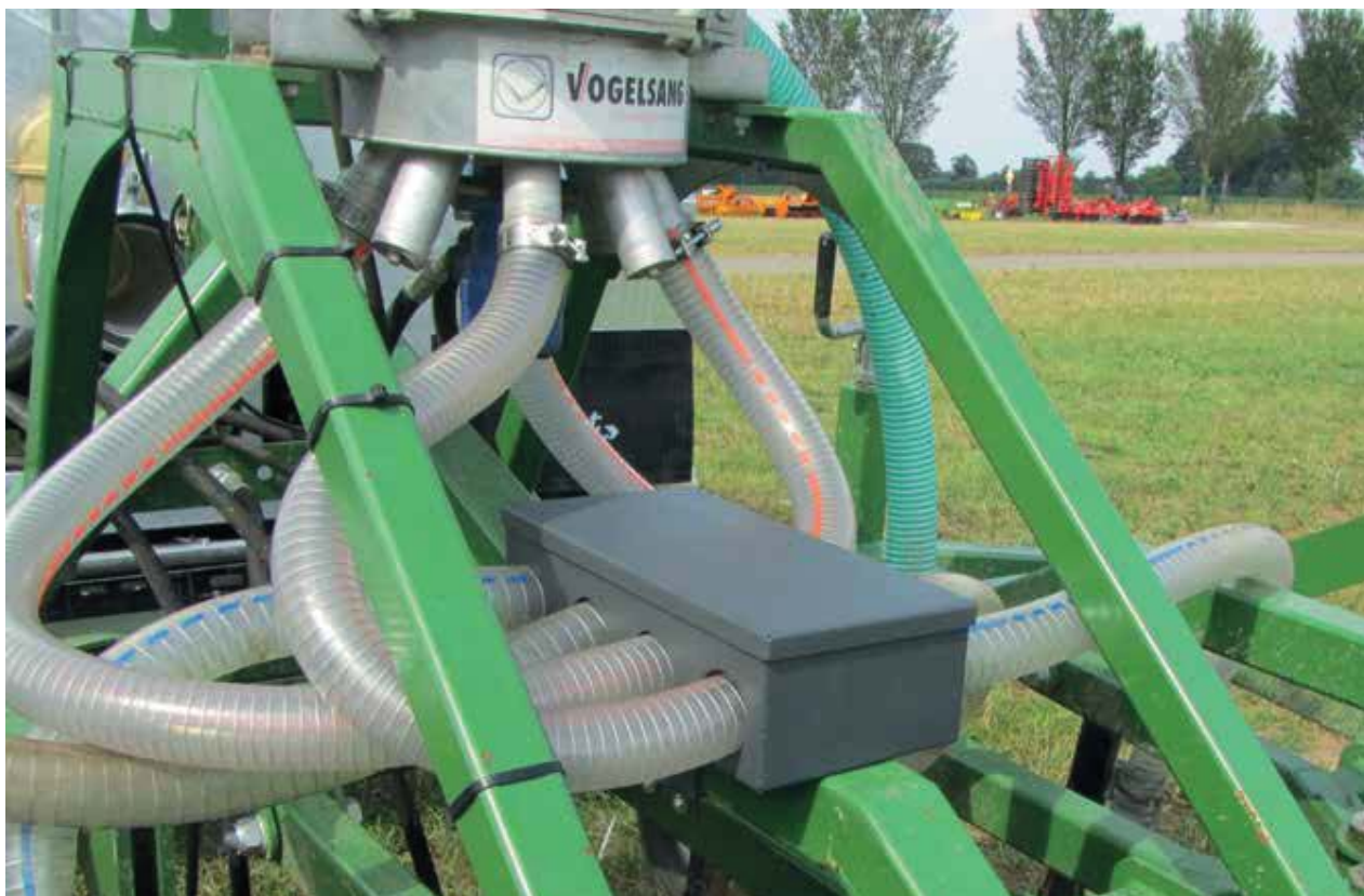
Abb. 3: Versuchsaufbau der Akustikbox zum Schutz der Sensoren
