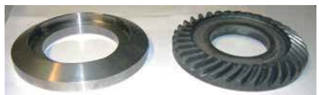
Abb. 3: Rohling links, fertiges Schmiedeteil rechts
