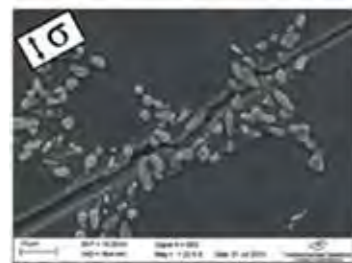
Abb.: (oben) Mikrostruktur AlSi7Mg0,3, (Mitte) Servohydraulische Prüfmaschine mit Questar-Fernfeldmikroskop zur Verfolgung von kurzen Ermüdungsrissen, (unten) Wechselwirkungen zwischen den Si-Partikeln und dem Risswachstum
