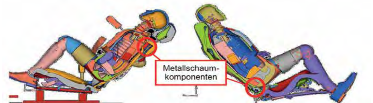
Abb.: Potentielle Einsatzfelder für Metallschaumprodukte in sicherheitsrelevanten Bauteilen eines Autositzes
