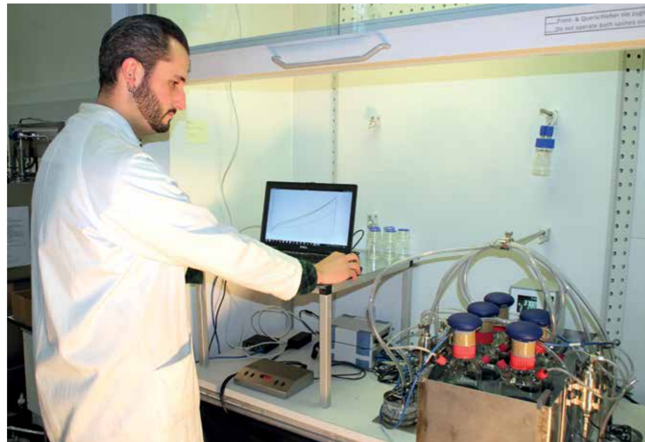
Abb. 1: Yieldmaster® System zur Messung des CH 4 – Gasbildungspotentials
