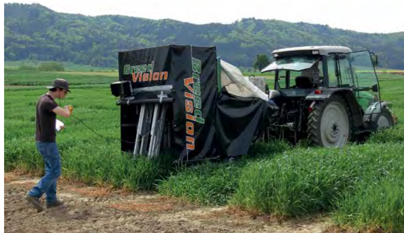
Abb. 1: BreedVision Sensorplattform bei Feldmessungen
