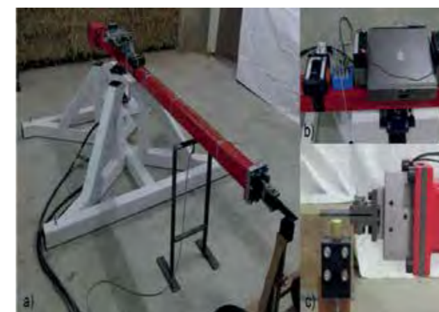
Abb. 3: a) Versuchsaufbau, b) Messwertverarbeitung und -speicherung, c) Sensorik und Werkzeugaufnahme
