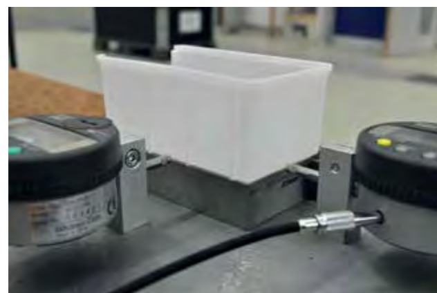
Abb. 2: Wechselwirkungsuntersuchungen der Spritzgießparameter zwischen Realversuch (links) und Simulation (rechts) bei den Maßen eines kastenförmigen Spritzteils
