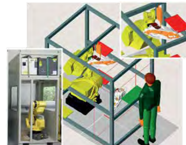
Abb.: Die neue HELLA-Schraubzelle im Simulator und in der Realität (Foto unten links: HELLA)
