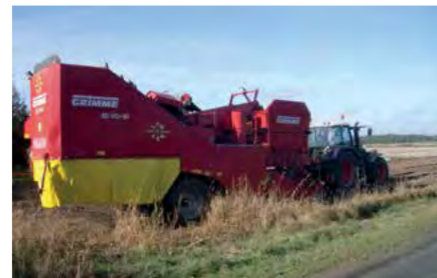
Abb. 3: Gezogener Kartoffelroder mit Zwischenbunker während des Testlaufs der KartoffelApp
