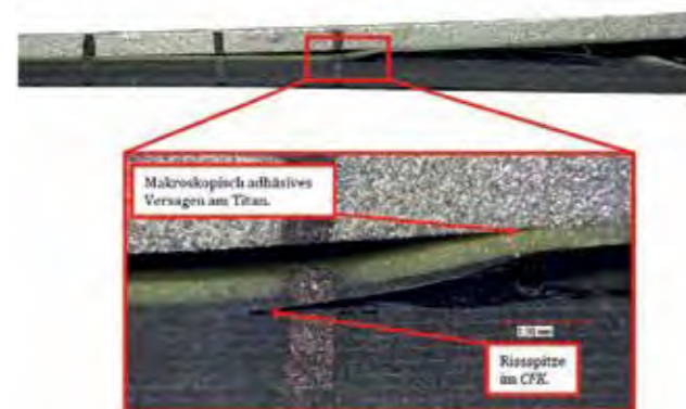
Abb.: Mechanische Prüfung einer Titan/CFK-Verbindung mit einem Wechsel der Rissapitze vom CFK in die Grenzschicht zwischen Titan und Klebstoff
