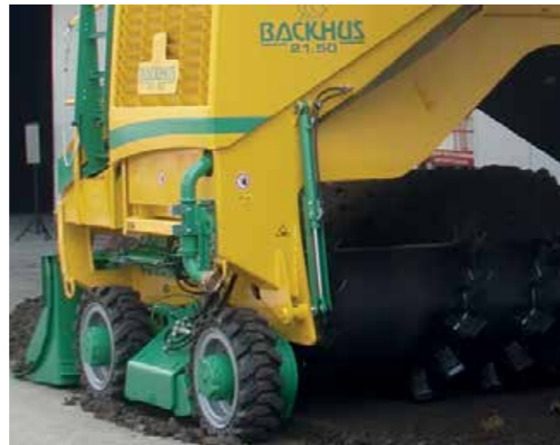
Abb. 2: Optionales Radfahr- und Radhubwerk sowie Rotorwelle eines Umsetzers
