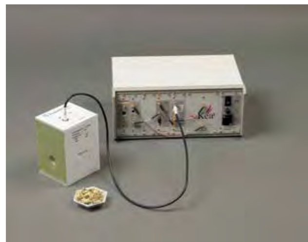
Abb. 1: Realisierter NMR-Agro-Sensor bestehend aus Messspule und Kea®-Spektrometer.
