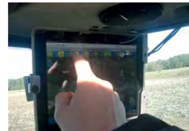
Abb. 5: In der Schlepperkabine installierter Tablet-PC (Ipad) mit der KartoffelApp
