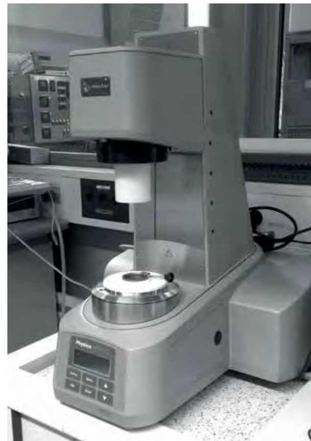
Abb. 1: Rheometer der Fa. Anton Paar, Typ Physica MCR 101
