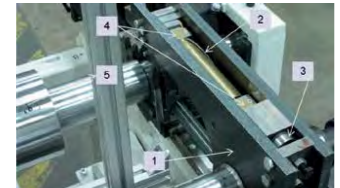
Abb. 2: Umgebautes Lager der Formatwalze (1: Aktives Lager, 2: Piezoaktor, 3: Vorspannscheiben, 4: Ausgleichselemente, 5: Formatwalze)
