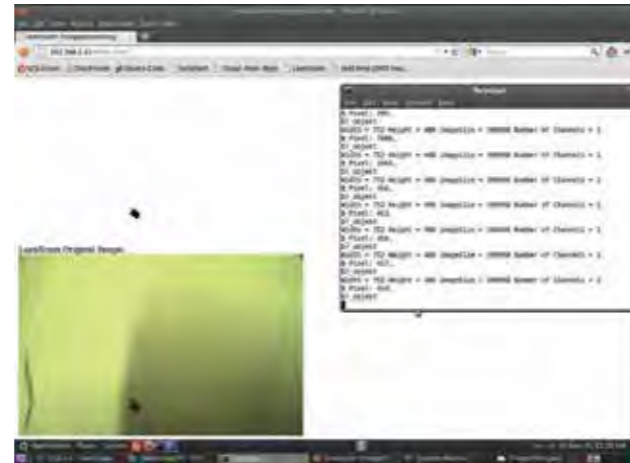
Abb. 3: Foto von dem Insekt auf dem Klebestreifen (unten); Insektendetektion durch Bildverarbeitungs-Algorithmen (oben)
