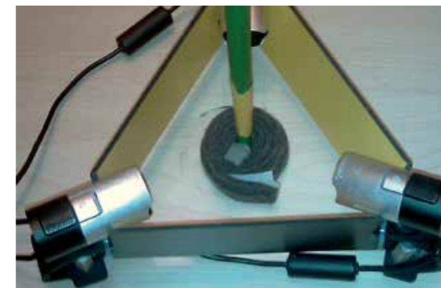
Abb. 1: Aufbau des Drei-Kamera-Systems
