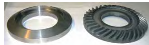
Abb. 3: Rohling links, fertiges Schmiedeteil rechts
