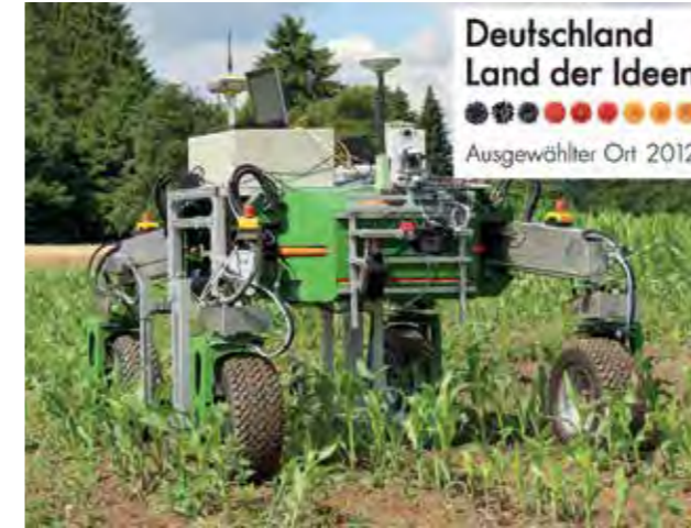
Ein Roboter mit Zukunftsmusik - BoniRob, der autonome Feldroboter, soll die Arbeit der Pflanzenzüchter erleichtern.
