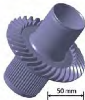
Abb. 1: 3D-geschnittene Antriebswelle aus einem Motorrad
