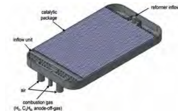
Abb. 1: Katalytischer Brenner mit integriertem Reformer
