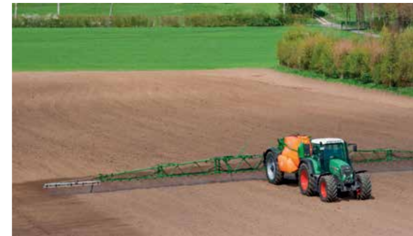
Abb.: Gezogene Pflanzenschutzspritze UX mit Super-L-Gestänge der Fa. Amazone
