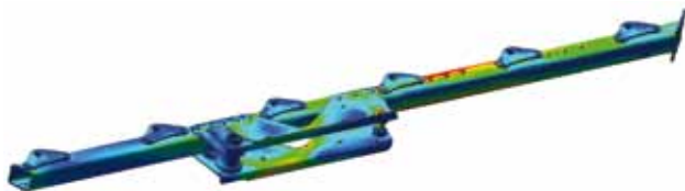
Abb. 2: FEM-Simulation des Hauptrahmens als Grundlage für die Gestaltoptimierung
