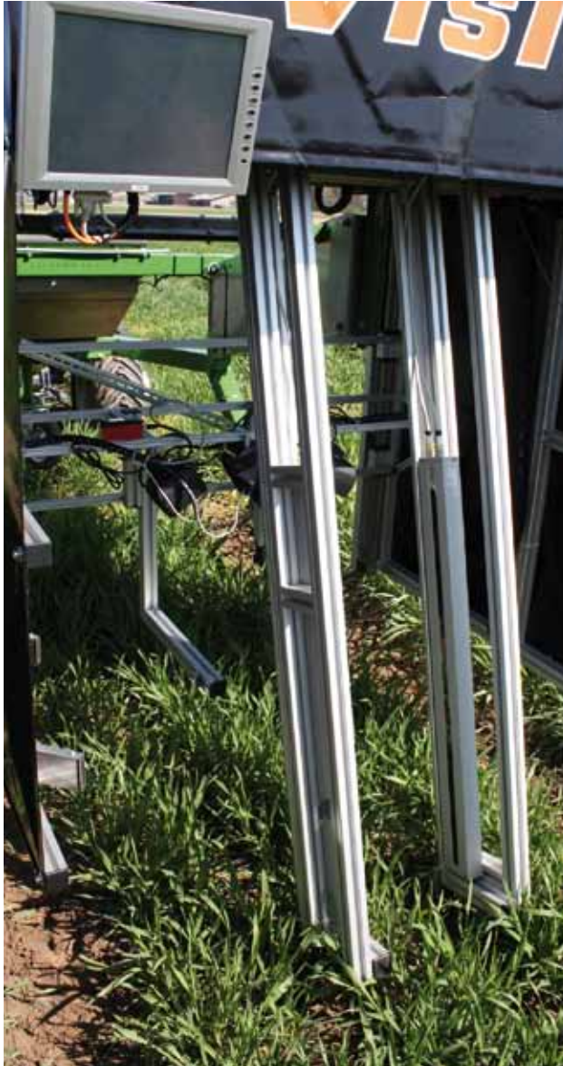
Abb. 2: Sensormodul mit optoelektronischen Sensoren und User-Interface
