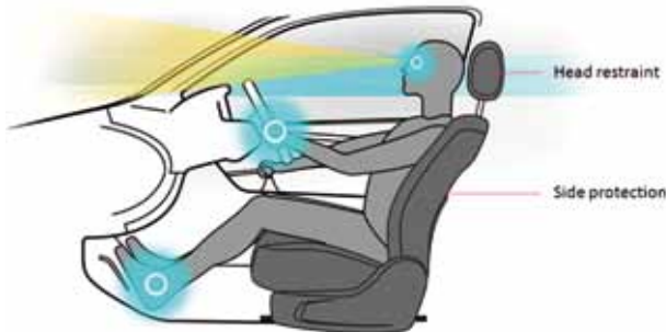
Abb. 1: Potenzielle Einsatzgebiete für Aluminiumschaum im Autositz
