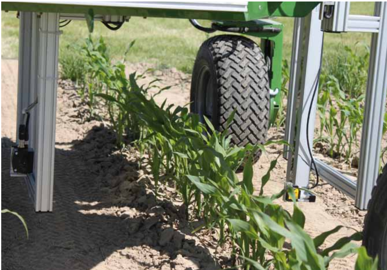
Abb. 1: Lichtgitter, 3D-Kameras und Lasersensoren zur zerstörungsfreien Messung von Pflanzeigenschaften (am Beispiel Mais) im Feldversuch.
