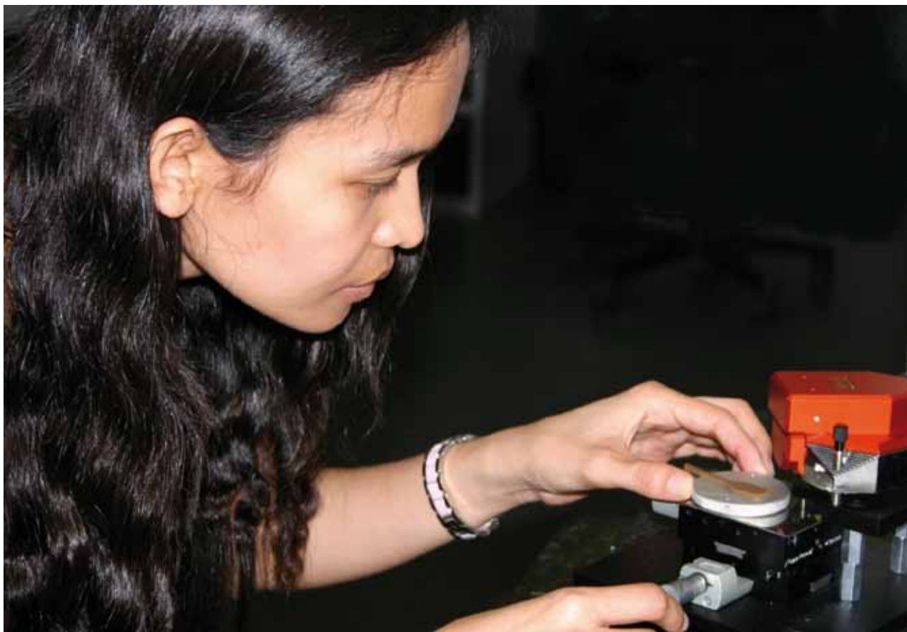
Abb. 1: Untersuchung der Phasenmorphologie mit dem Atomic Force Microscope
