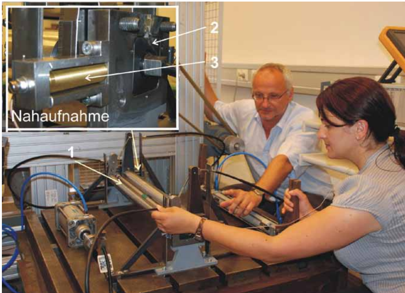
Abb. 2: Versuchsanlage mit Piezoaktoren ((1) Walzensystem, (2) Elastisches Lager, (3) Piezoaktor)
