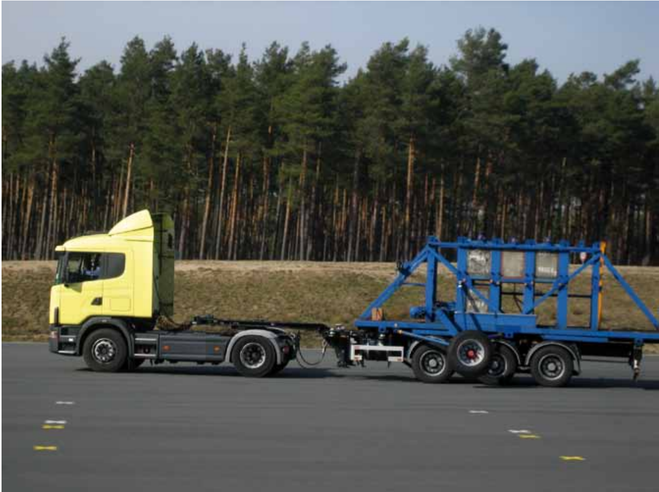
Abb. 2: Mit Messtechnik ausgestatteter Sattelzug für Fahrdynamikversuche
