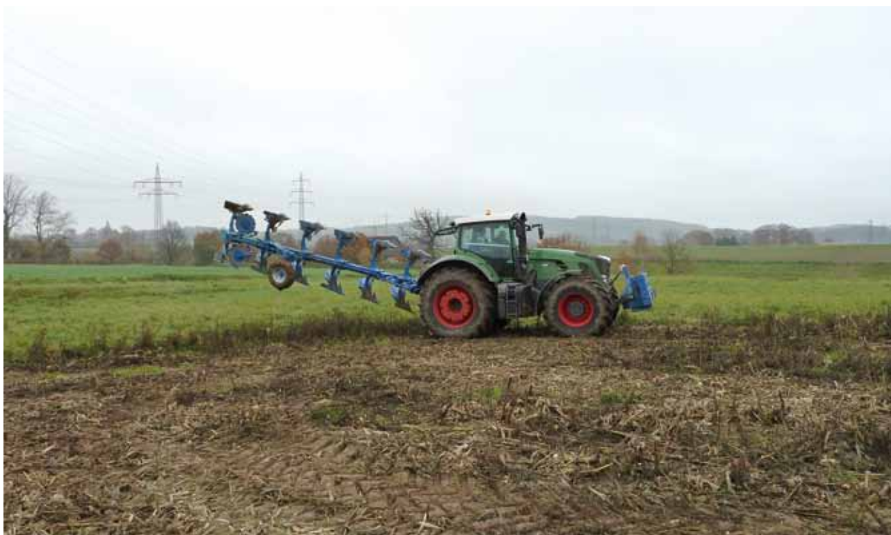
Abb.: Anbaudrehpflug im Feldeinsatz
