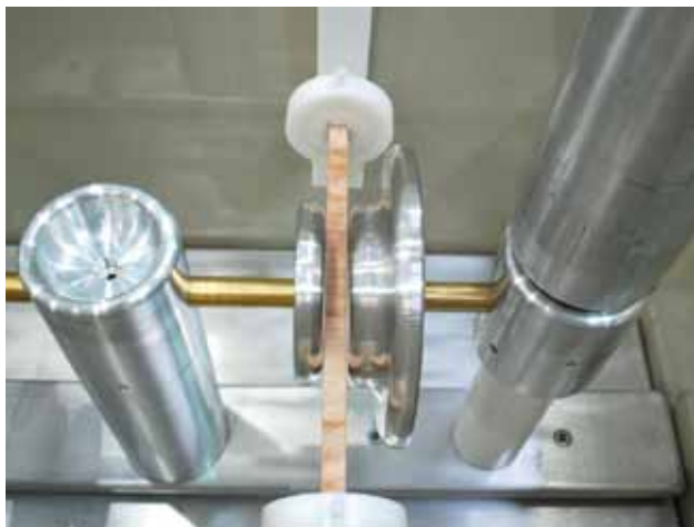
Abb. 1: Versuchsaufbau ohne Ölfüllung mit eingebautem Prüfling zwischen den Elektroden.
