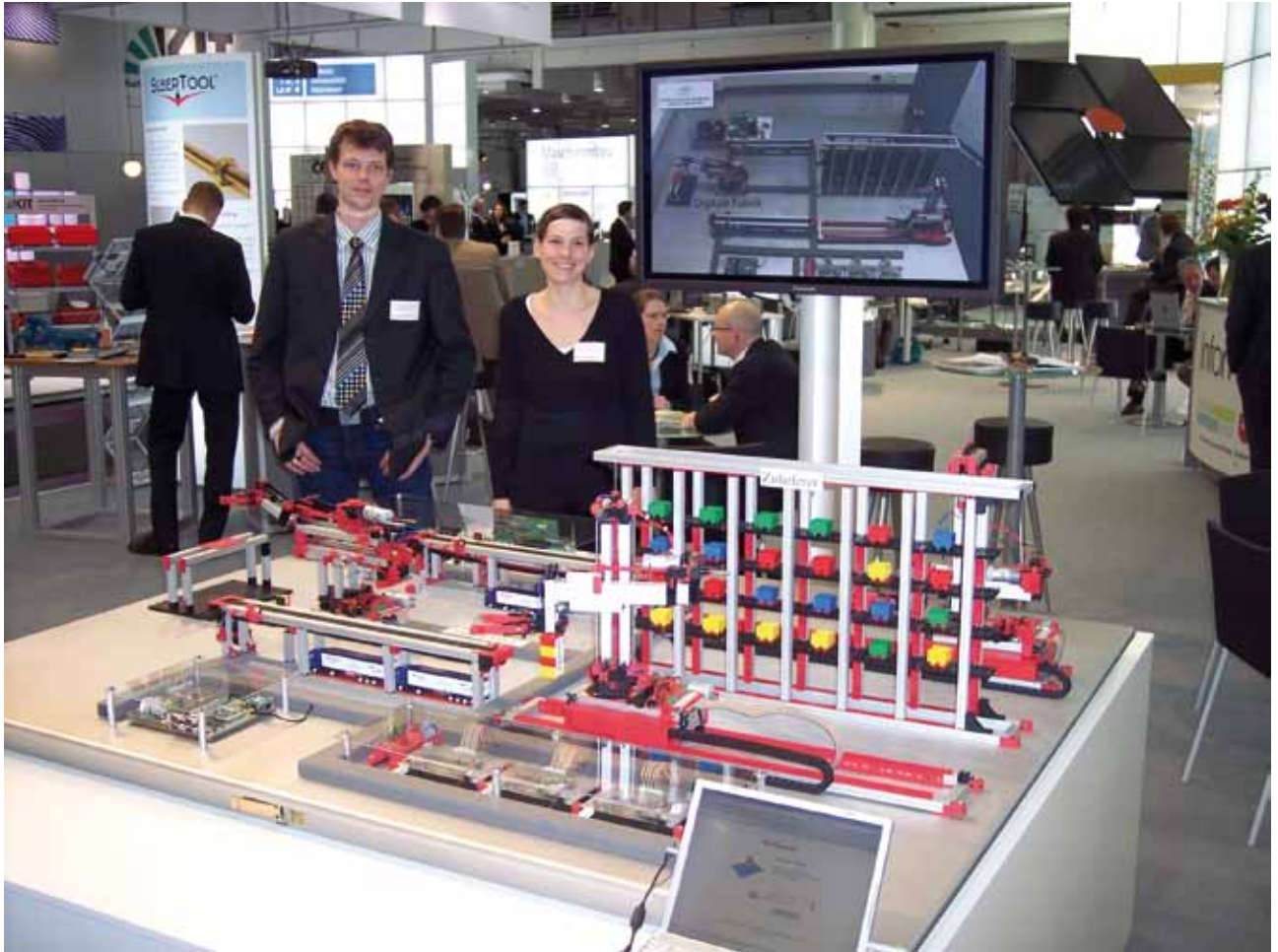
Abb.: Im Lager des Zulieferers (rechts) stellen zwei Roboter Teile für den Transport zur digitalen Fabrik (links) zusammen.
