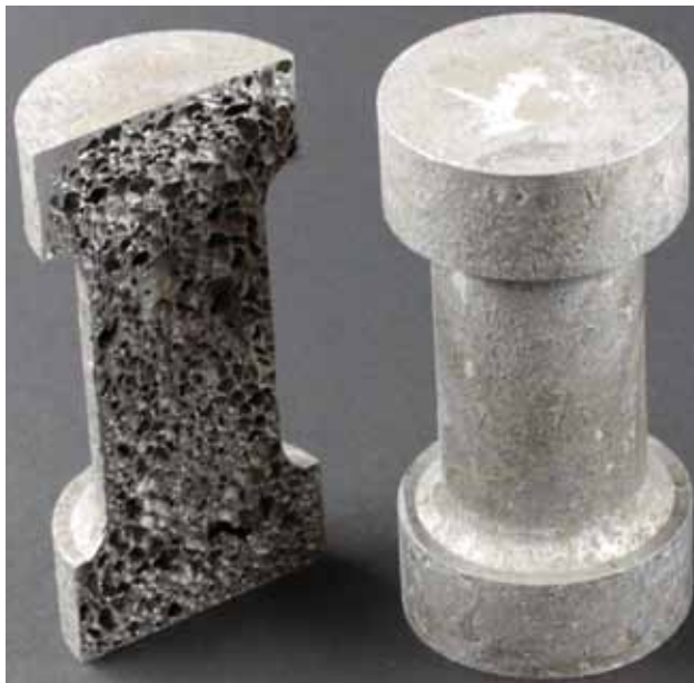
Abb. 2: Aluminiumschaumproben des Projektpartners Alulight.
