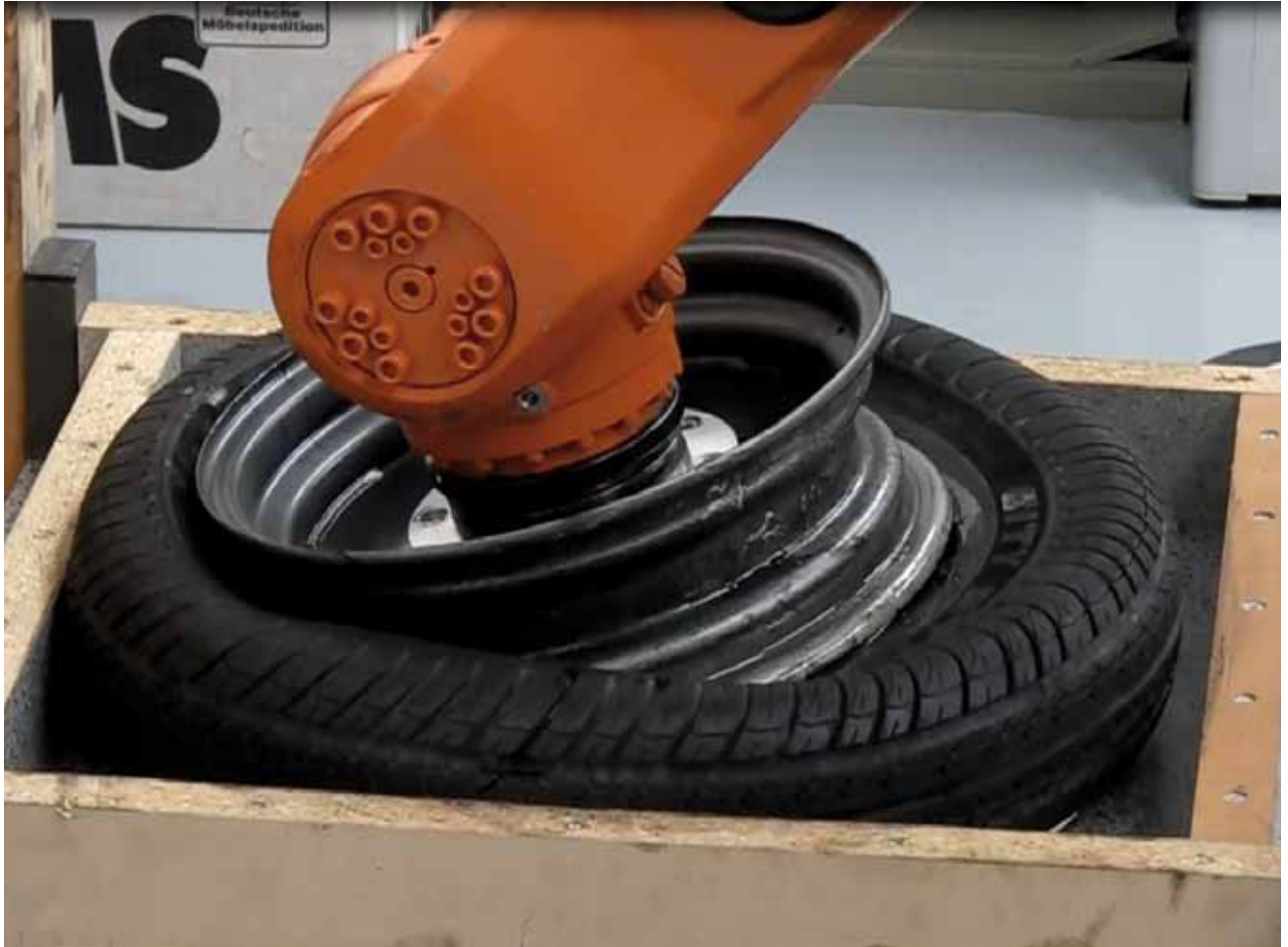
Abb.: Test der robotergestützten Montage von Felge und Reifen im Roboterlabor der Hochschule Osnabrück
