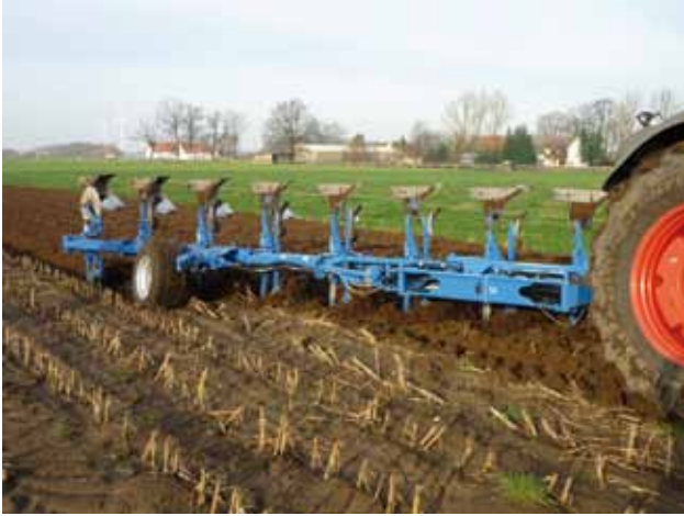
Abb. 1: Anbaudrehpflug der PAVO-Serie im Feldeinsatz
