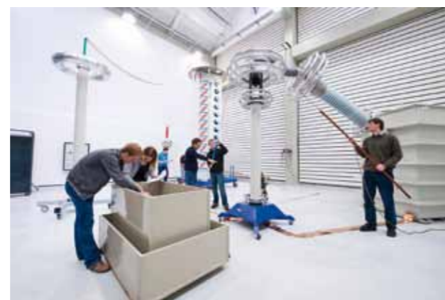
Abb. 2: Neue Hochspannungserzeuger für 400 kV-Wechselspannung und 1200 kV-Impulsspannung
