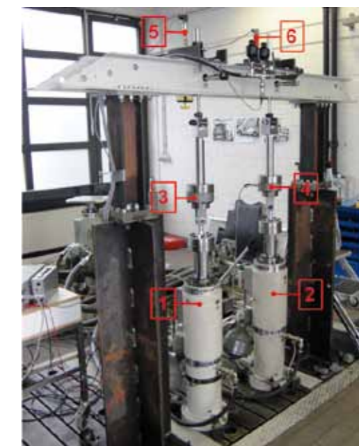
Abb. 1: Mit Messtechnik ausgestattetes Versuchsfahrzeug (1,2: Hydropulszylinder mit Wegsensoren, 3,4: Kraftmessdosens, 5,6: Drucksensoren)
