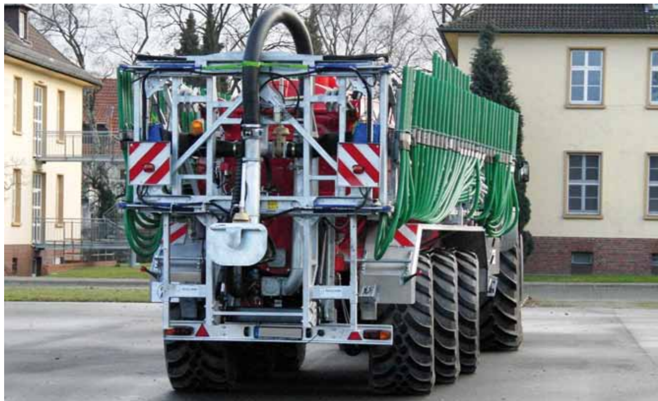
Dieser Anhänger fährt im „Hundegang“ – seine Räder laufen spurversetzt, so dass der Boden geschont wird.
