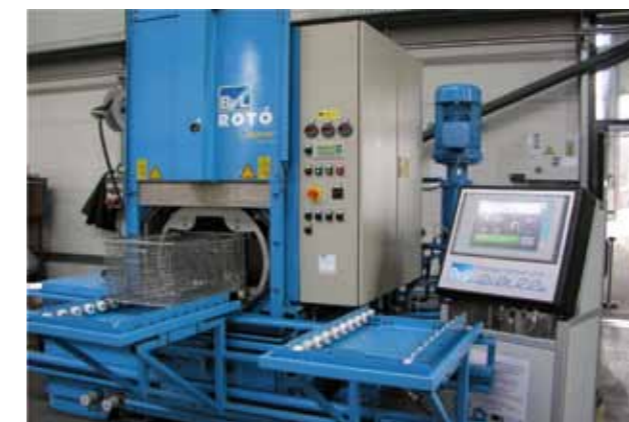
Abb. 1: Industriewaschanlage der Firma BvL Oberflächentechnik GmbH, Emsbüren, mit Sensorsystem zur Überwachung der Reinigungsflüssigkeit
