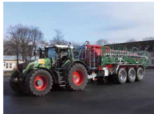
Abb.: Moderner Flüssigmisttankwagen mit Tridemfahrwerk und Untenanhängung (K80)
