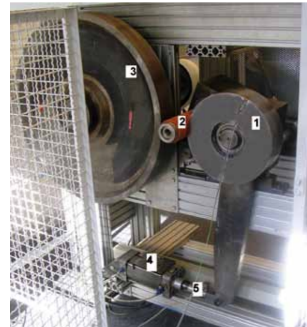
Abb. 1: Versuchsstand (1: Andruckwalze, 2: Elastomerbeschichtete Walze, 3: Gegenandruckwalze, 4: Pneumatischer Zylinder, 5: Kraftsensor)
