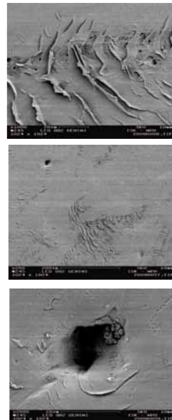
Abb 2: Rasterelektronenmikroskopaufnahme einer beschädigten Membran
