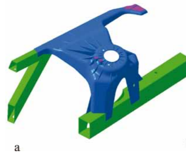
Abb.: (a) Zu analysierende Demonstratorbaugruppe „Federbeinaufnahme“ und (b) Arbeitspakete des Forschungsschwerpunkts SafeConnect.
