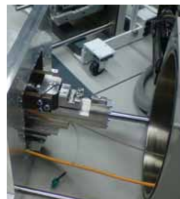
Abb. 1: Im Rahmen des Vorhabens entwickelte Miniaturprüfmaschine zur Ermüdungsprüfung innerhalb (in-situ) eines Rasterelektronenmikroskops
