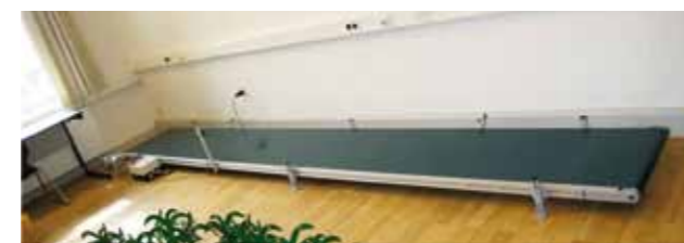
Abb. 2: Förderband für dynamische Messungen von Pflanzenparametern im Labor
