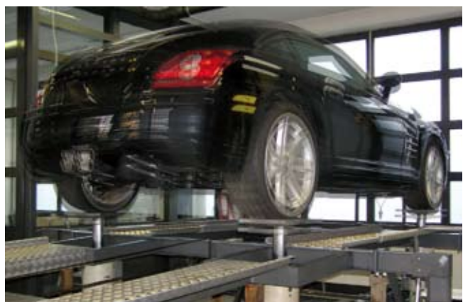
Abb.: Schwingungsuntersuchungen auf einem servohydraulischen Straßensimulator
