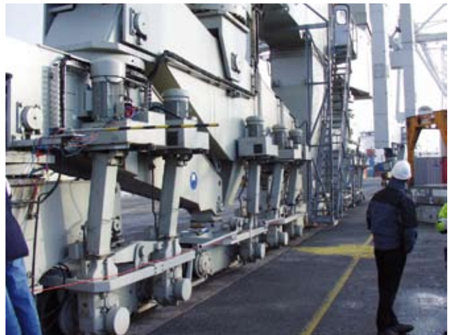
Abb.: Fahrwerkmotoren der untersuchten Krananlage
