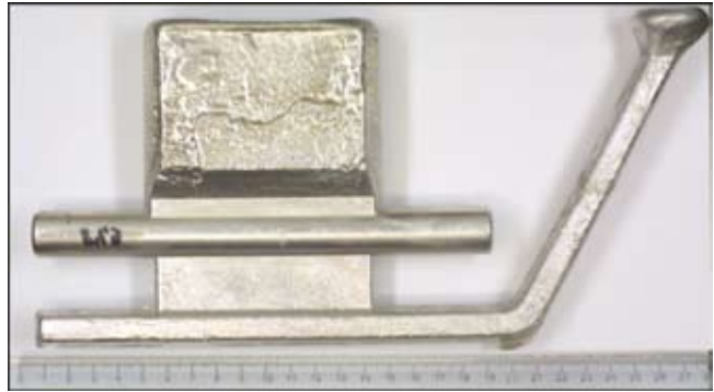
Abb.: Unter realitätsnahen Bedingungen gegossene Proben für Zug- und Ermüdungsversuche
