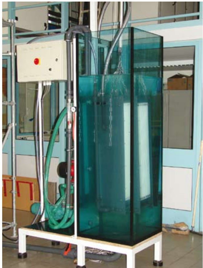
Abb. 2: Technikumsanlage mit einem getauchten Filtrationsmodul der Microdyn-Nadir GmbH
