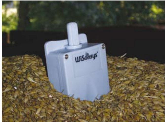
Abb.: Test mit drahtlosen Sensornetzwerken für Applikationen in der Landwirtschaft (Inspire & Innovate Projekt: WISENSYS; Sensor: WirelessValue / Emmen, Niederlande)
