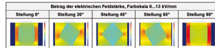
Abb. 2: Numerische Berechnung der elektrischen Felder kurz vor dem Durchschlag
