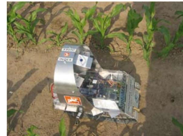
Abb. 1: Autonome Feldroboter optoMAIZER
