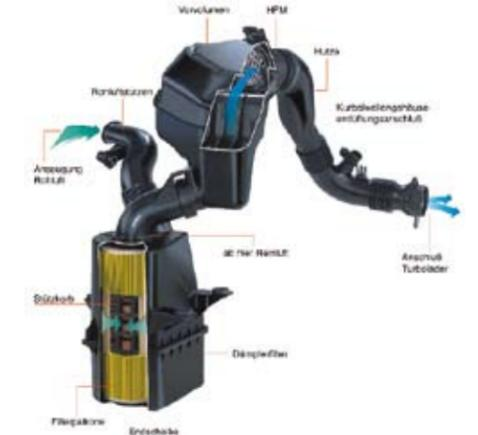
Abb. 2: Ansaugstrang eines 1,4l-TDI-Motors mit Komponenten aus TPE.
