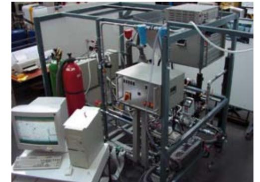
Abb. 1: Brennstoffzellenprüfstand
