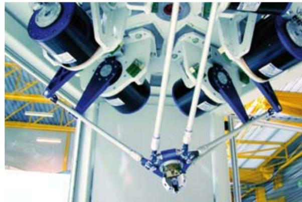
Abb.: Parallelroboter HEXA
