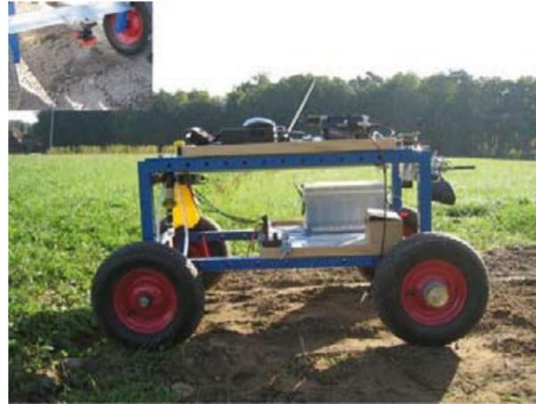
Abb. 2.: Messwagen mit Sensorsystem und Mikrosprayer zur Unkrautregulierung
