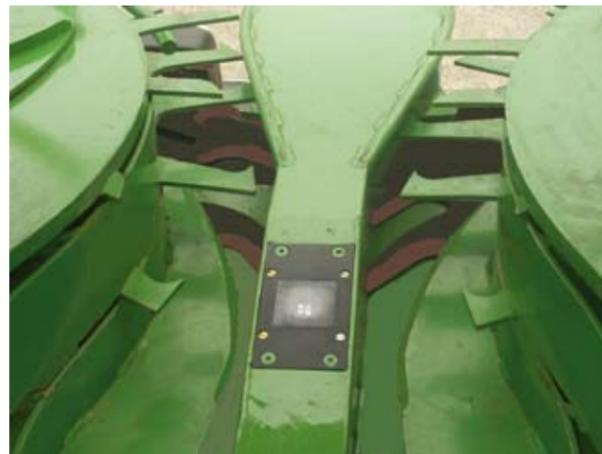
Abb. 2: Sensorsystem „AutoScan“ im Maisgebiss des selbstfahrenden Maishäckslers BigX (Maschinenfabrik Bernard Krone)
