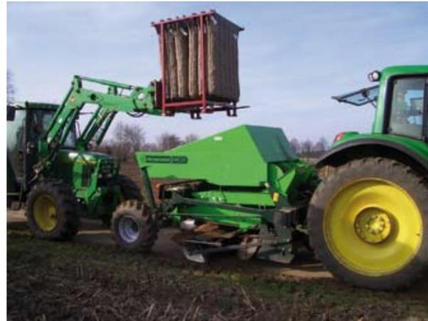
Abb. 1: Befüllen einer Legemaschine aus Vorkeimsäcken
