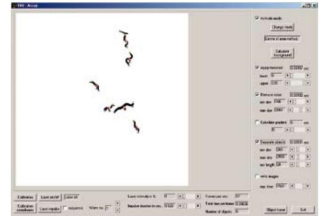
Abb. 2: Benutzeroberfläche zur Bildverarbeitung, Laser- und Kameraansteuerung (mit einem Ergebnis der Bildverarbeitung)
