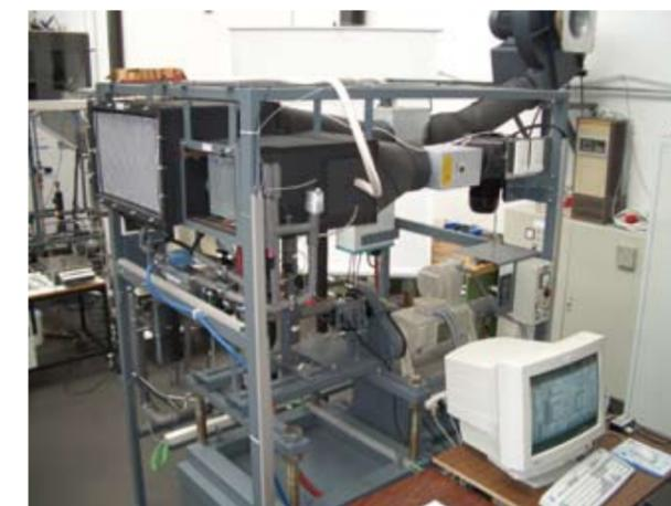
Abb. 1: Versuchsaufbau Ermittlung Verdichterdaten
