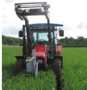
Abb. 1: Schlepper mit Sensorsystemen zur Messung des Pflanzenbestandes
