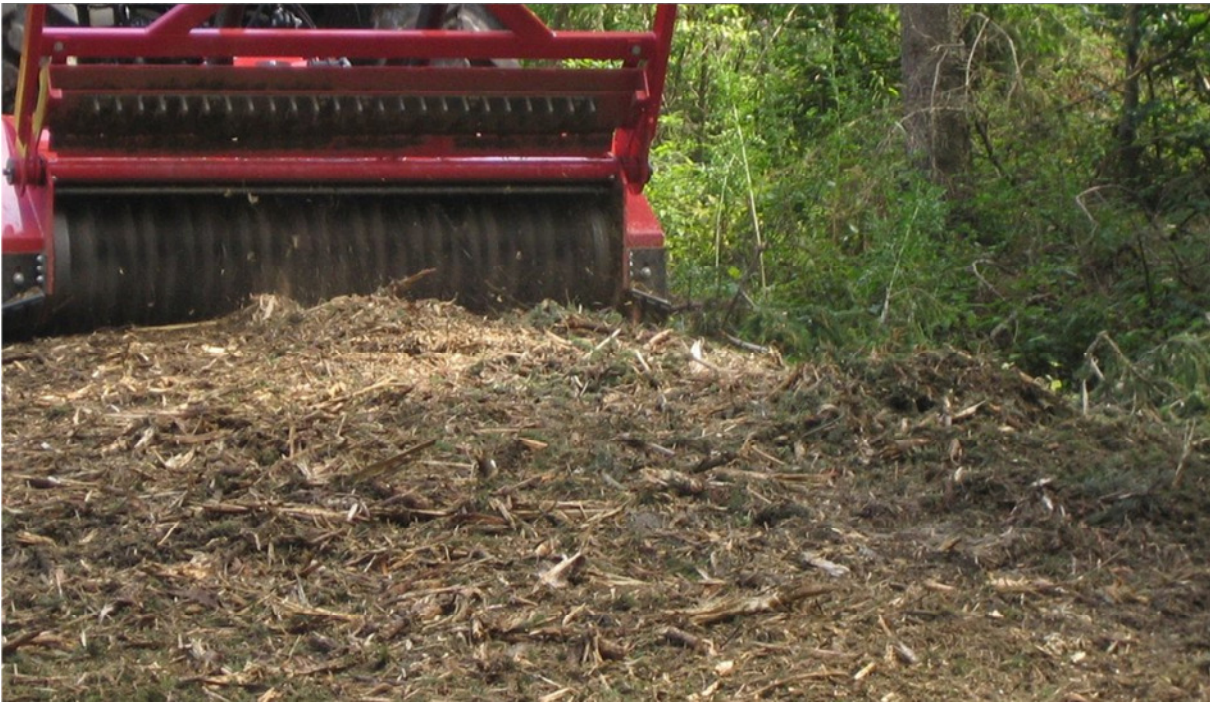
Abbildung 6: Oberflächennahes Fräsen mit einer Mulchfräse von Prinoth
