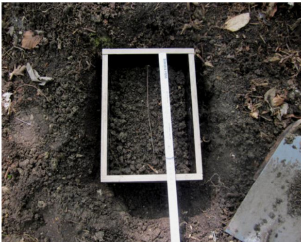
Abbildung 3: Die sogenannte Dichtung-Box, welche in situ um die lebende Baumwurzel angebracht wird.
