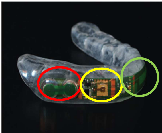
Abbildung 6: Okklusions-Schiene mit Batterie (rot eingekreist), piezoelektrischen Sensor (gelb eingekreist) und Sender/Empfänger (grün eingekreist) [9].
