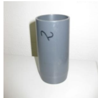
Abb. 29: Ausstechzylinder zur Wurzelprobenentnahme
