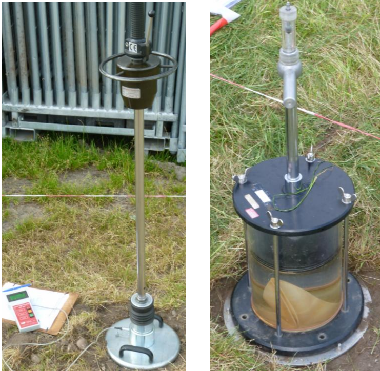
Abb. 28: Dynamischer Plattendruckversuch (links), Ballonverfahren (rechts)
